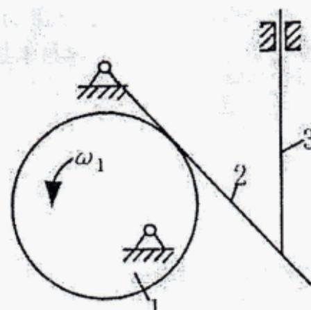
3、(10分) 对图示机构进行受力分析, 考虑到摩擦, 画出各构件的受力分析图。其中  $P$  为驱动力,  $Q$  为生产阻力。(图中转动副外的大圆为摩擦圆, 不考虑惯性力, 摩擦角大小自定)
