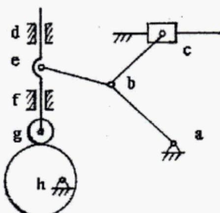
2、(10分) 求图示机构的  $P_{13}$ ，如果已知构件1的角速度为  $\omega_1$ ，求  $\omega_3$  (用  $\omega_1$  表示)。
