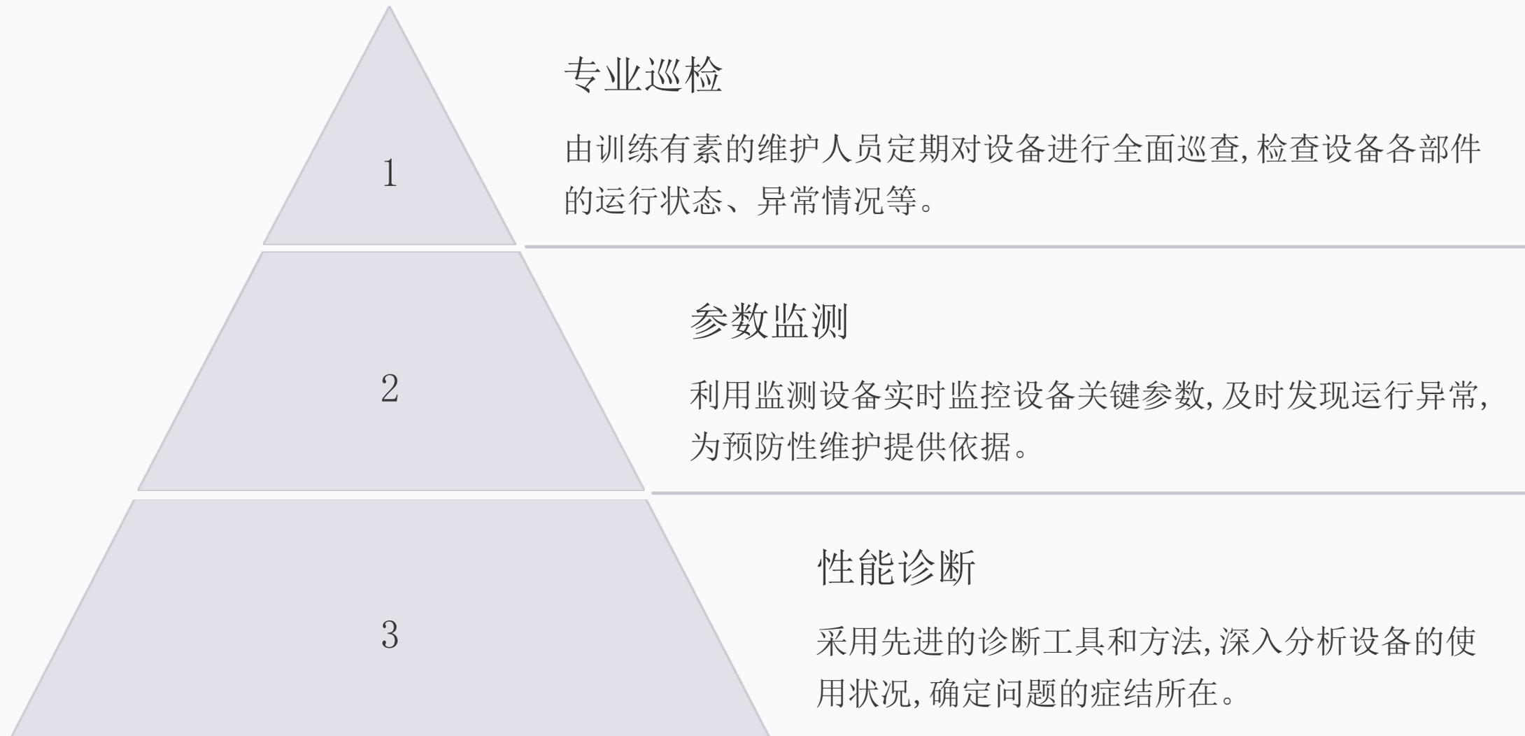
定期对设备进行全面检查和性能诊断是预防设备故障的关键。通过专业人员的巡查、关键参数的监测, 以及先进诊断手段的应用, 能够及时发现设备隐患, 并制定针对性的维护计划, 延长设备使用寿命。
