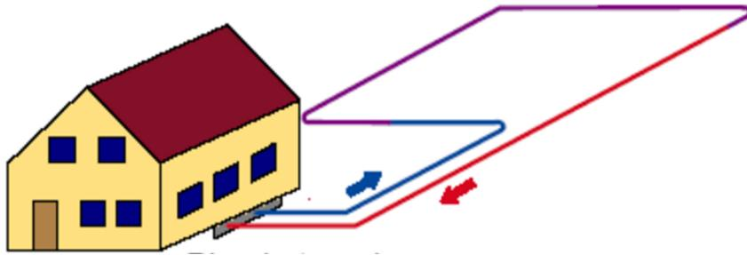
图 2.1 水平埋管地源热泵系统
