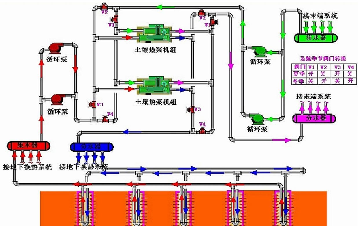
图 3.1 地源热泵热水系统原理图
