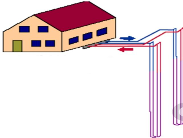
图 2.2 垂直埋管地源热泵系统
