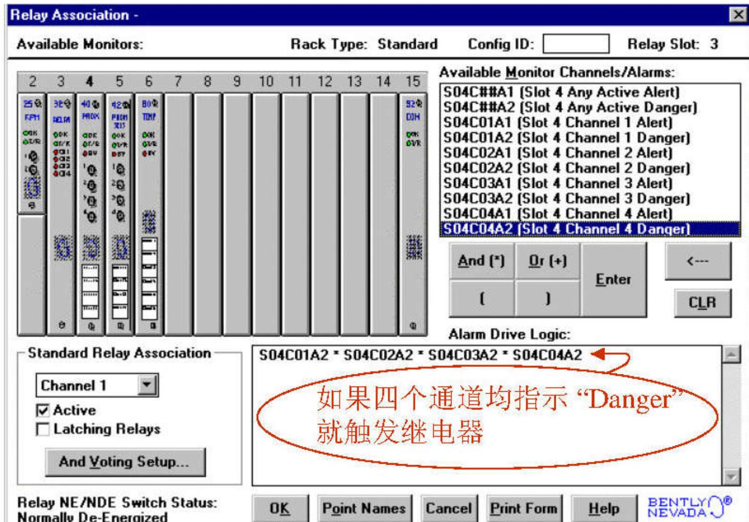
**机器保护**— 当与System 1\*软件连接时，它还提供连续状态监测信息，以用于主动维护计划。
