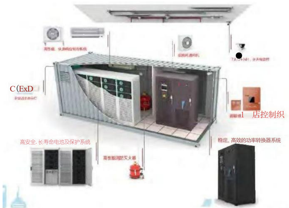
图10:大型集装箱式储能系统结构图
