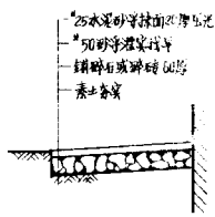
④ 碎石砖水泥散水
