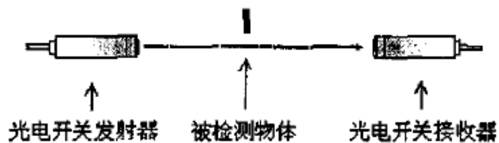
图 1-2 直射式光电传感器结构示意图
