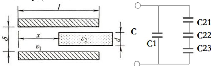
解: 如图所示,  $C_{21}$ 、 $C_{22}$ 、 $C_{23}$  串联为  $C_2$ , 然后与  $C_1$  并联。
