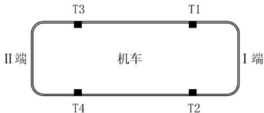
图 6 地面感应接收器在机车上安装位置示意图
