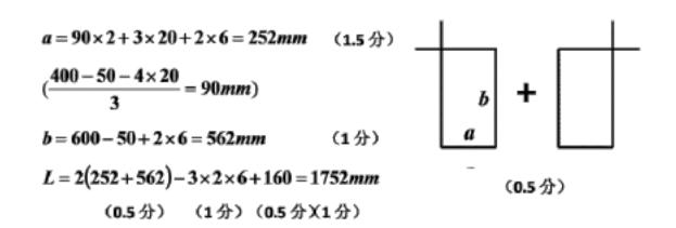
2、某现浇砼梁 L1: 梁长 6m,断面 b×h=250mm×600mm,钢筋简图见表。③ 号弯起钢筋弯起角度为  $45^\circ$  ,弯直部分长度为 150mm;④号箍筋弯钩形式为  $135^\circ$  / $135^\circ$  ,弯钩增长值为 160mm。(6 分)试计算梁 L1 中钢筋的下料长度。(箍筋  $\Phi$  6@200)
