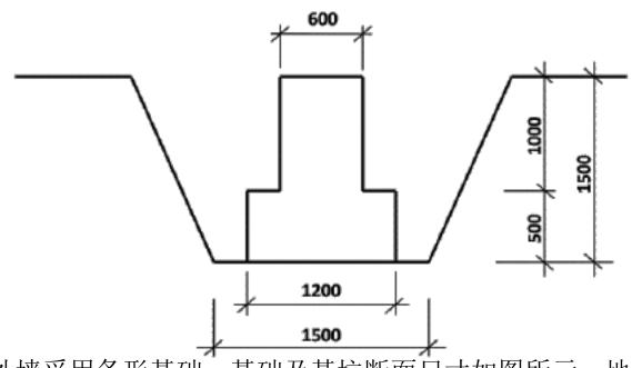
1、某建筑物外墙采用条形基础,基础及基坑断面尺寸如图所示。地基为粘土,边 坡坡度为1:0.33。已知
