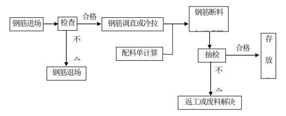
钢筋按设计规定的规格、型号、尺寸、数量,根据施工规范规定的弯钩、接头等计算配料单,经复核无误后准确下料。
