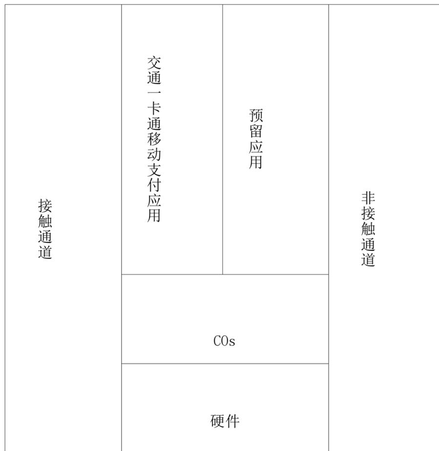
图 5 外置式 SE 逻辑结构
