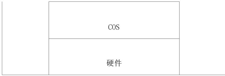
图 1 (U)SIM 卡 SE 逻辑结构
