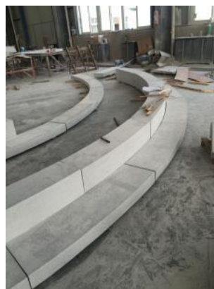
图 4.0.1-1 圆弧段 BIM 模型 图 4.0.1-2 按模型试制预拼
