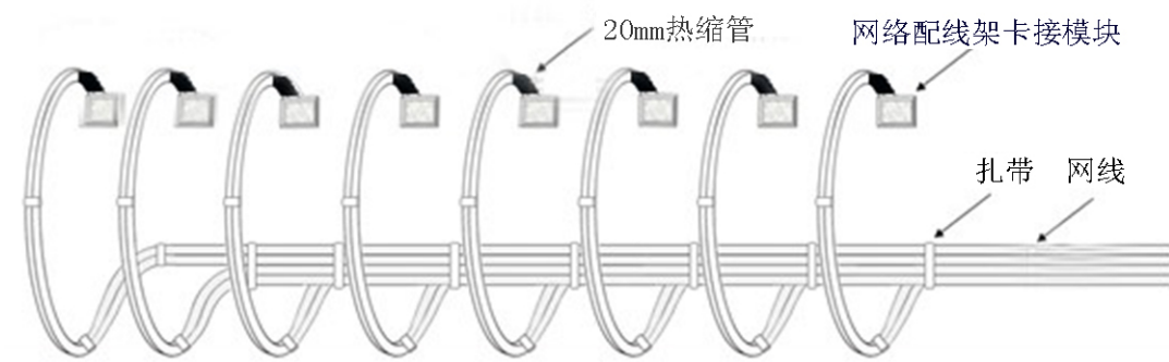
图 3.6.3 网络配线架侧成端示意图
