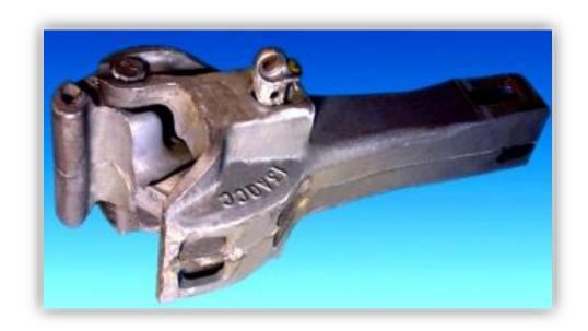
车钩安装在车体底架的车钩箱内 → 实现牵引力和制动力的传递
