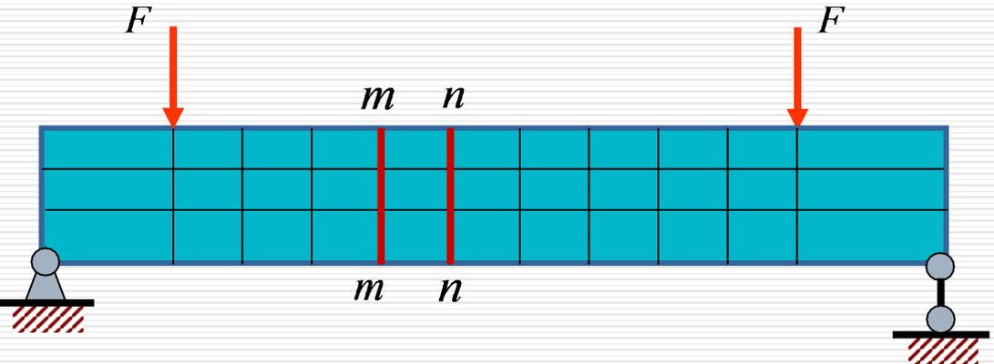
✓1、变形前互相平行的纵向直线、变形后变成弧线，且凹边纤维缩短、凸边纤维伸长。
