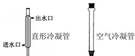
图 2 冷凝装置
