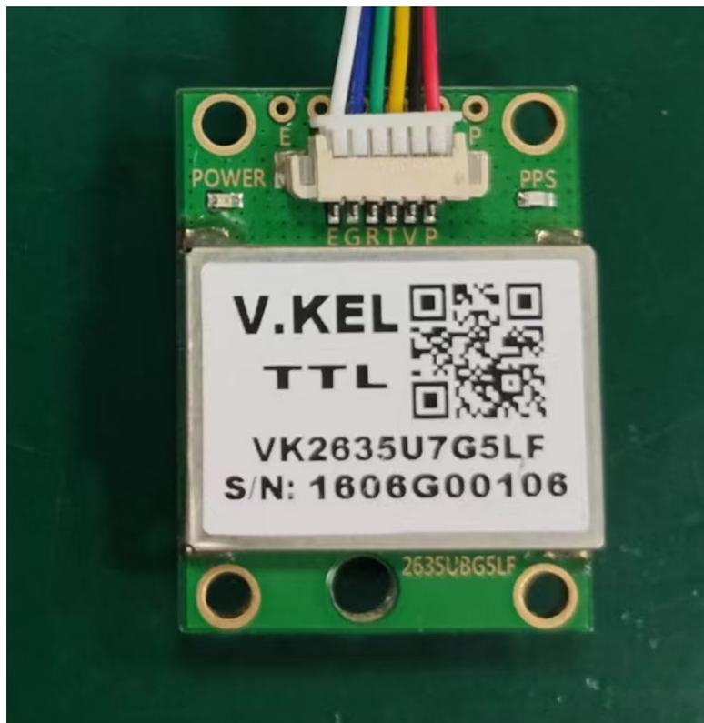
图 3.7 VK2635U7G5LF GPS 信号接收模块实物图
