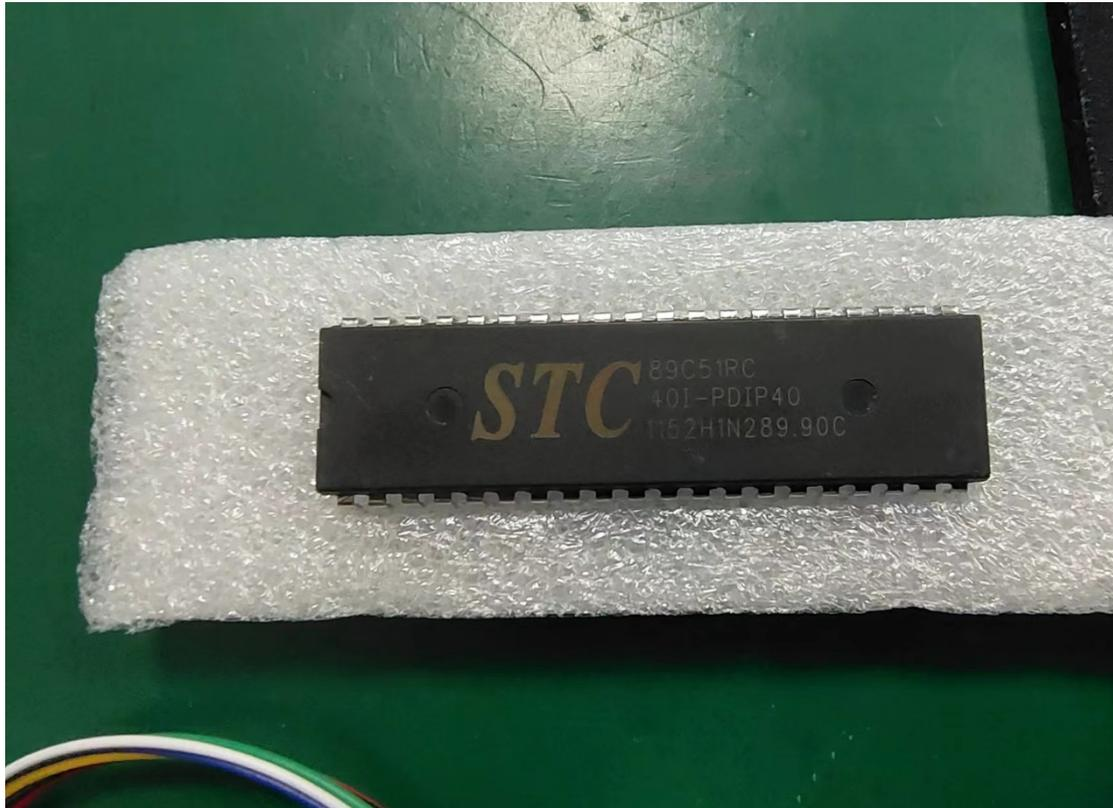
图 3.2 STC89C51RC 单片机实物图
