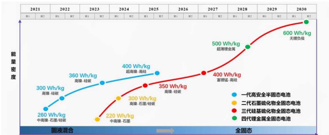
图 7：欧阳明高院士团队高安全高比能固态电池研发技术路线图
