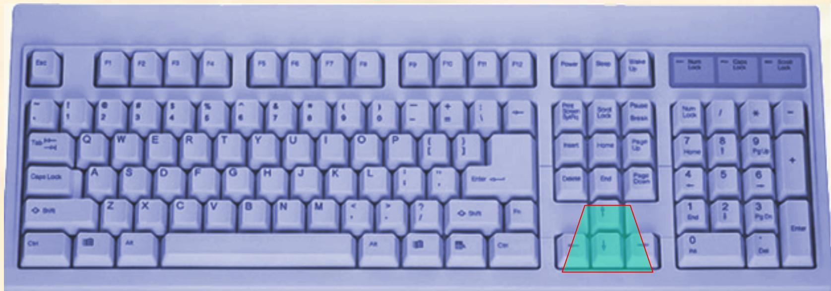
**方向键：**可将光标上下左右各个方向移动。
