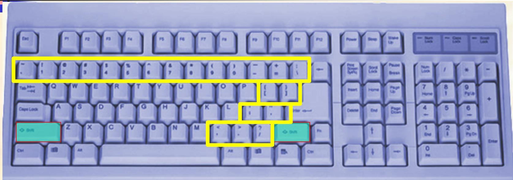
**Shift** 键（又叫做上下档切换键）使用方法：按住它，再按双字符键输入双字符键上面的字符，当**Caps Lock**键切换为输入小写字母状态时，按住 **Shift** 键，再按英文字母键，则输入大写英文字母，若**Caps Lock**键切换为大写输入状态时则相反。
