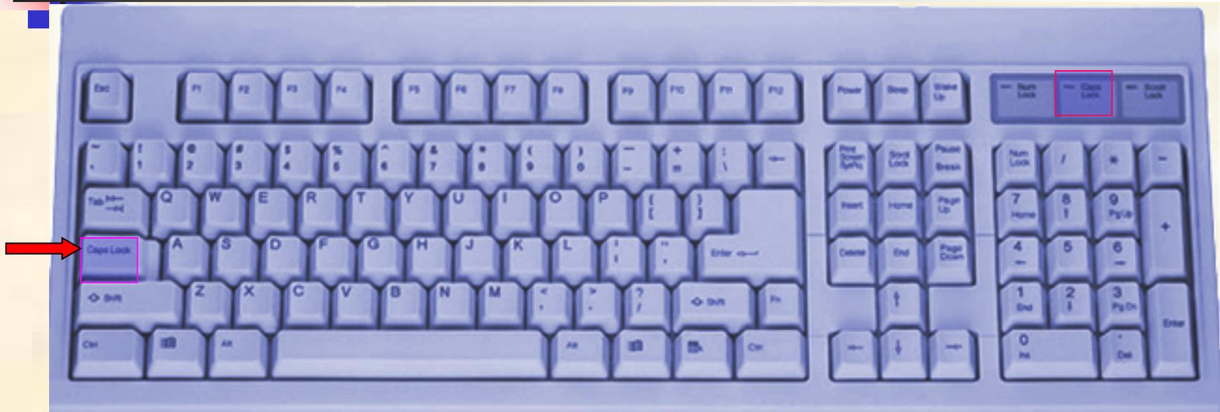
控制键中的**Caps Lock**（又叫大写字母锁定键），用于大小写英文字母的切换。如果按下此键，键盘右上角的指示灯亮，是大写字母状态；如果指示灯灭，则是小写字母状态。
