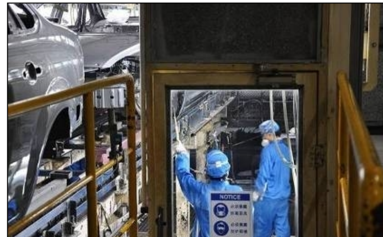
Cavity Wax Injection การฉีดแว็กซ์โพรง
