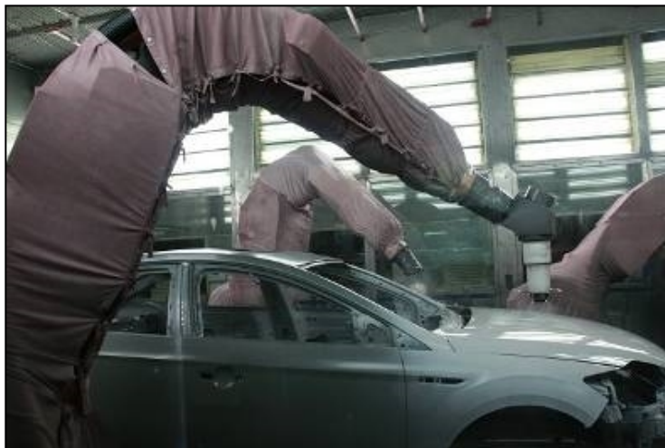
Automatic Spraying Robot หุ่นยนต์พ่นอัตโนมัติ
