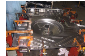
Welding of rear floor งานเชื่อมข้างหลัง
