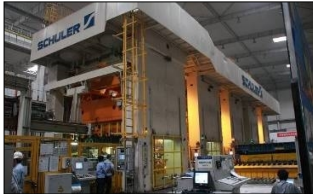
Stamping Production Line, Composed of Multiple Presses สายผลิตการปั๊มขึ้นรูป โดยประกอบด้วยเครื่องอัดหลายเครื่อง
