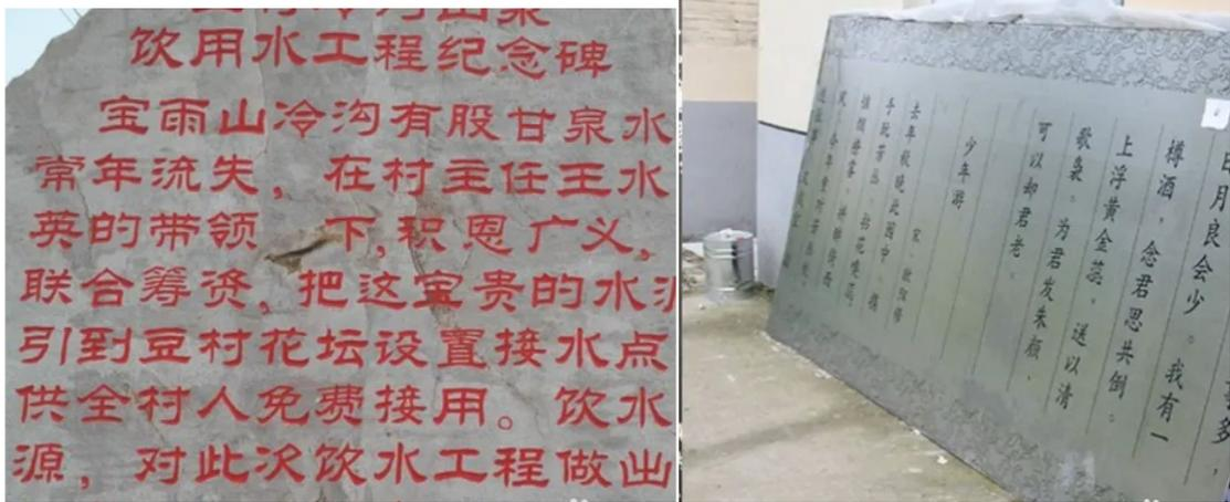
3. 用大理石腐蚀液，腐蚀液的雕刻成本低，大批量雕刻速度快，产量较高，以盐酸为主的腐蚀混合液与大理石中的碳酸钙发还是能化学反应生成可溶性盐和沉淀物，然后用清水将其冲洗干净就可以腐蚀出雕刻效果。但是这个方法有一个缺点，就是局限性比较大，在大理石和汉白玉上（比较软的石材）雕刻，其他石材或者别的材质基本都雕刻不了，腐蚀的深度比较浅，有一毫米就算比较深的。腐蚀刻字多用于工业加工，铝、铜、不锈钢等金属材质，可以批量加工，图案文字可以做到很小，成本最低。
