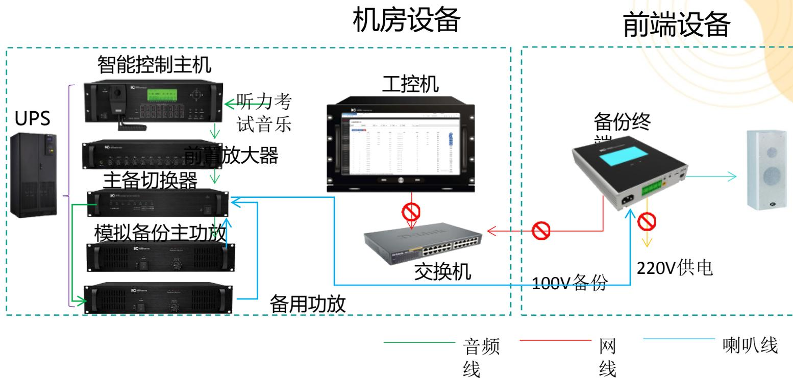
含听力备份的机房部署：智能控制主机、主备切换器、模拟备份主功放、备用功放、T-6239FA（开关）、UPS不间断电源等。
