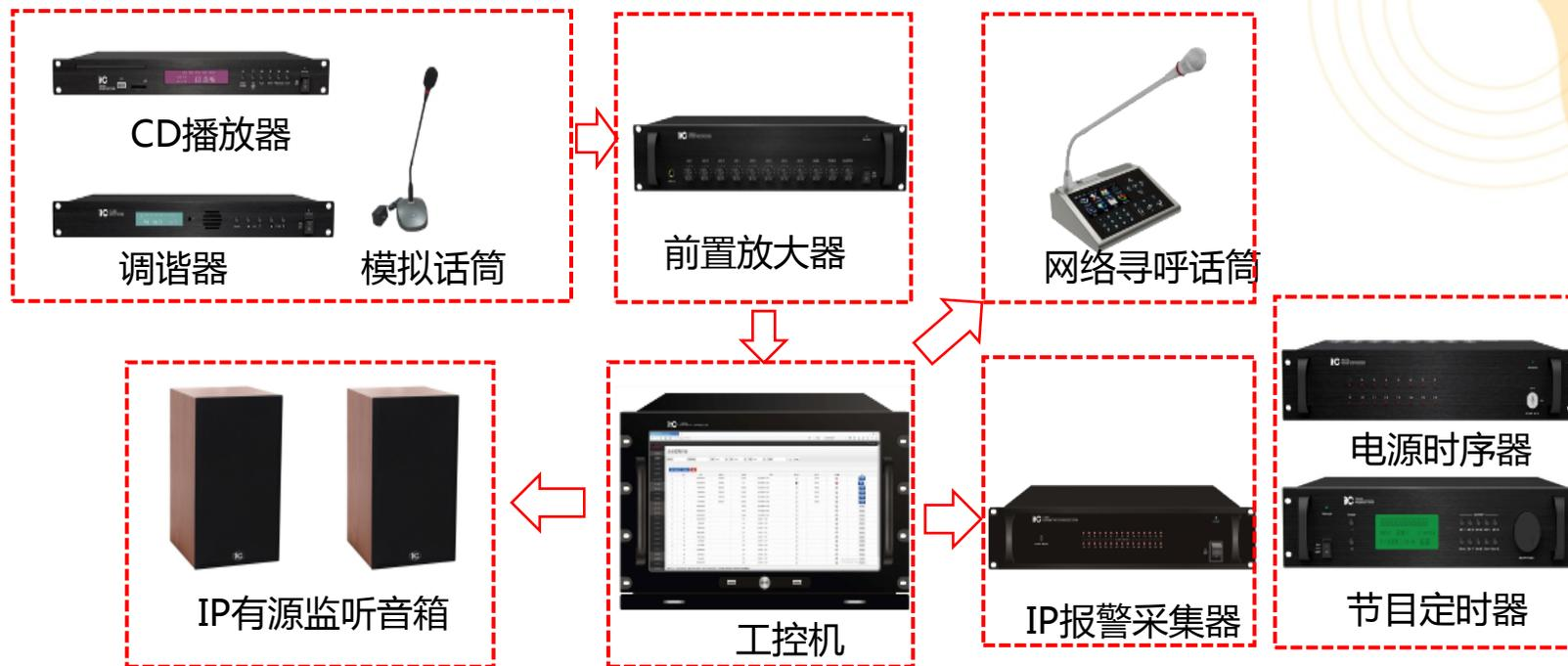
常规的中心机房主要部署设备：工控机、CD播放器、调谐器、模拟话筒、前置放大器、网络寻呼话筒、IP有源监听音箱、节目定时器、电源时序器等。
