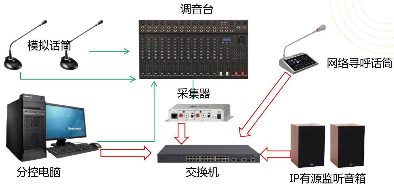
校园广播站主要部署设备：分控电脑1台、分控软件1套、调音台1台、模拟话筒2只以上，网络寻呼话筒1台、IP有源监听音箱1对等。
