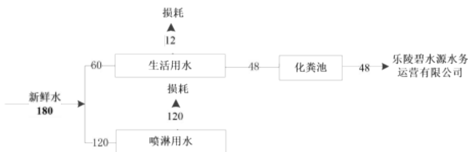
图 2-1 本项目水平衡图(单位: t/a)
