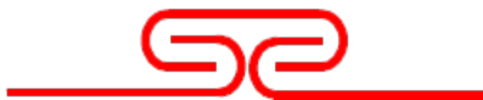
风管 C 形插条连接示意图
