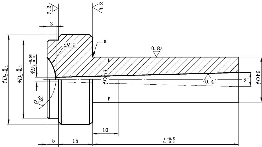
未注表面粗糙度  $R_a=6.3 \mu\text{m}$ ; 未注倒角  $1 \text{ mm} \times 45^\circ$ 。
