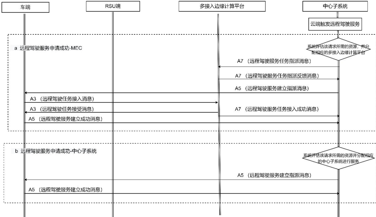
图3 远程驾驶服务申请（云控平台发起）交互流程
