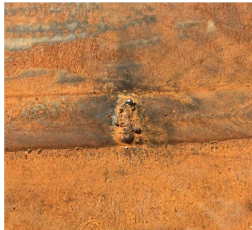
焊缝局部出现的焊瘤
