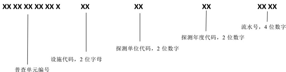
图 3 地下市政基础设施编码结构图
