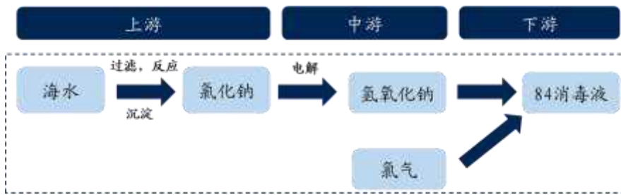
图 11：84 消毒液制备流程和产业链
