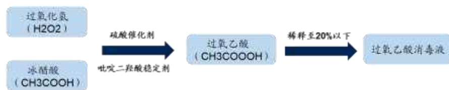
图 13: 过氧乙酸消毒液制备和产业链
