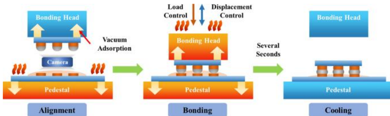
图10：公司 TCB 产品在 C2S 和 C2W 工艺的应用
