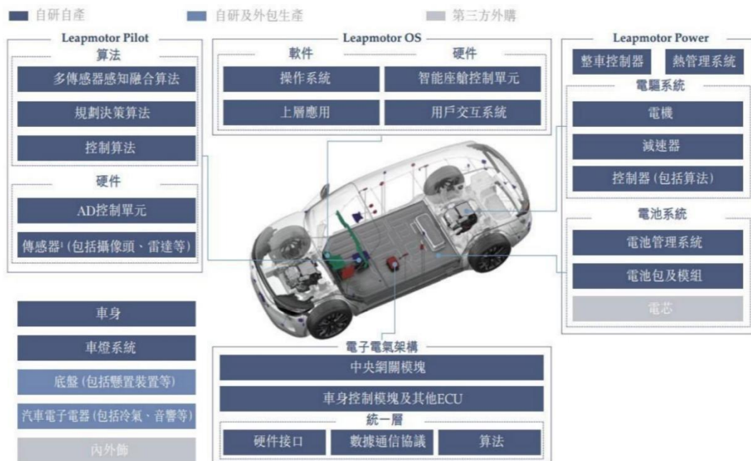
图表10: 零跑汽车全域自研示意图
