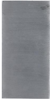
图 2-4 苯甲酸钠:正辛酸:钼酸铵 (3:1:1) 复配后的腐蚀形貌图
