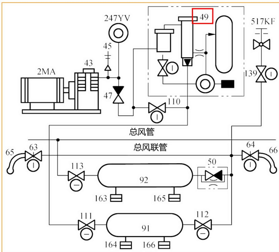
由空气处量为 $3-5\text{m}^3/\text{min}$ 的DJKG-A型空气干燥器49完成
