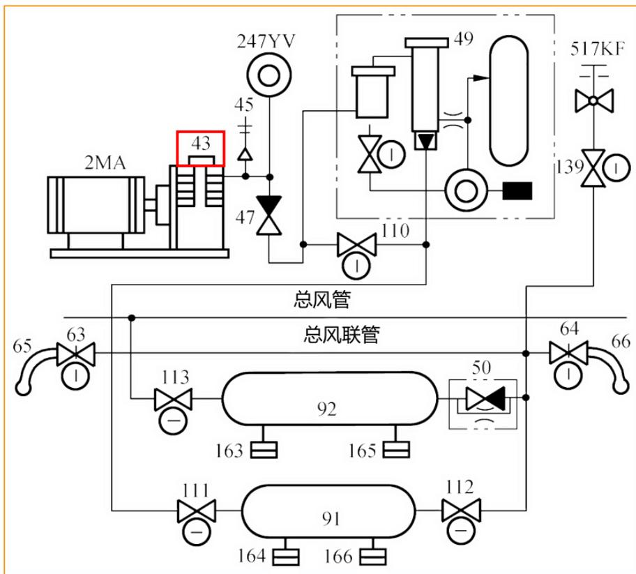
由一台生产量为 $3\text{m}^3/\text{min}$ 的VF-3/9型空气压缩机43完成
