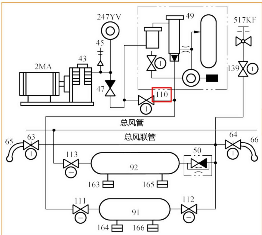
当排泄电空阀故障而使得消音器排风不止时，可关闭滤清筒下方的塞门，维持风源系统的工作
