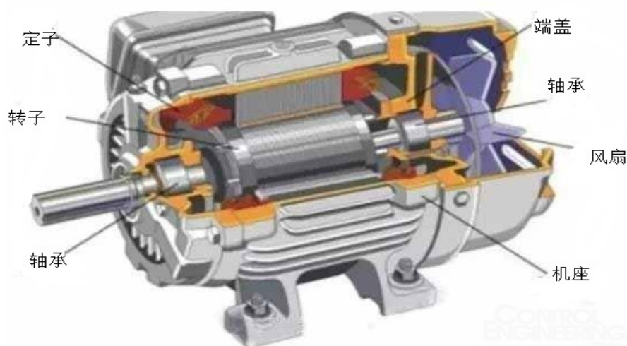
图 2-1 伺服电机整体结构及电机轴结构
