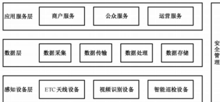
图 1 ETC 智慧停车系统总体架构
