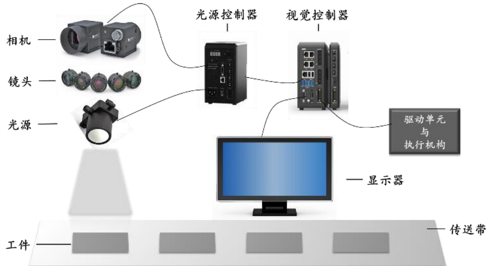
图表 3 机器视觉系统的典型构架
