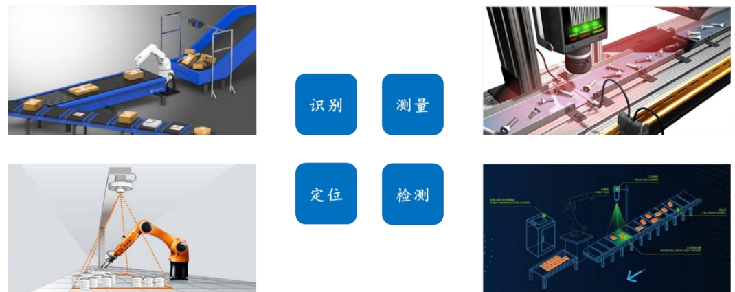
图表 2 机器视觉的四大基础功能
