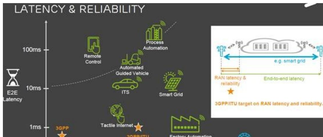
注：图中 2 个五角星表示时延和可靠性。时延用纵坐标表示，约为 0.5ms，可靠性则采用横坐标表示，对应  $1 \sim 10^{-5}$  的范围段。
