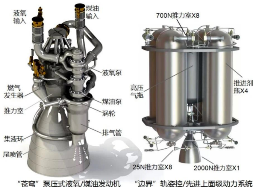
图13：液体火箭发动机结构示意图
