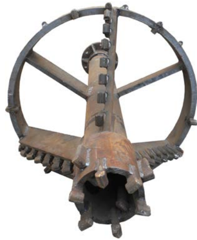
图 2.0.5-2 一次改进后的组合式钻头
