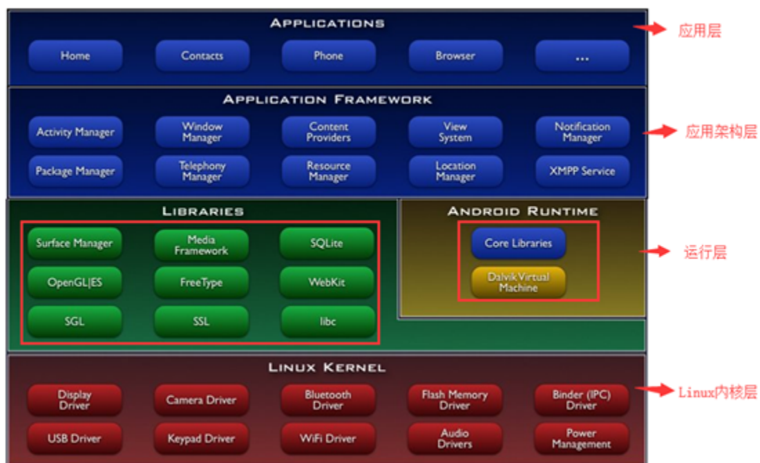
图 2.1 安卓系统架构图
