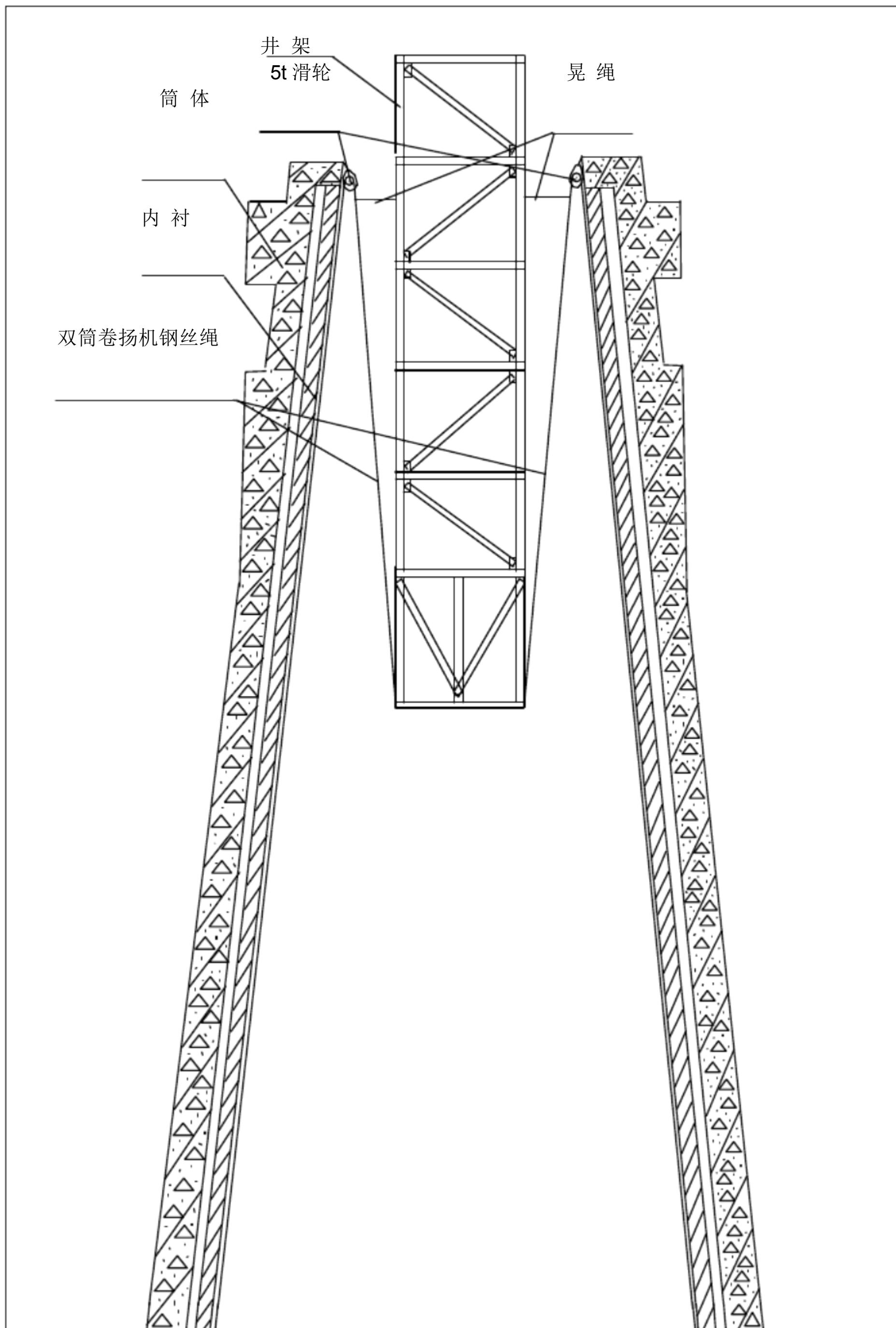
拆除顺序正好和安装顺序相反，原则上先装的后拆，后装的先拆。按本烟囱滑模的特点，采用半整体拆除方法。其顺序为：清理平台—内外模板—安全网、吊脚手—拉绳—辐射梁—环梁、门架—井架、鼓圈。
