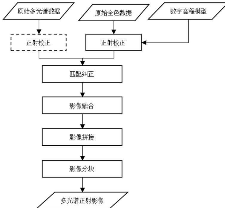
图 2 原始多光谱数据和原始全色数据预处理流程
