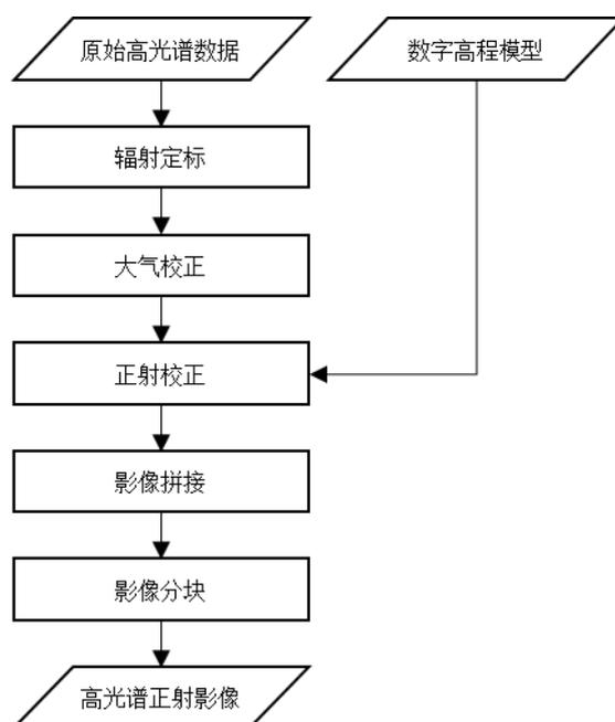
图3 原始高光谱数据预处理流程图
