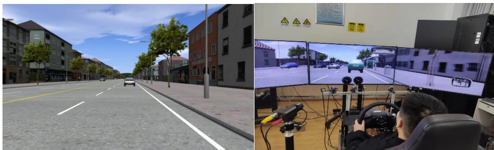
图 3.10 换道模拟实验场景
