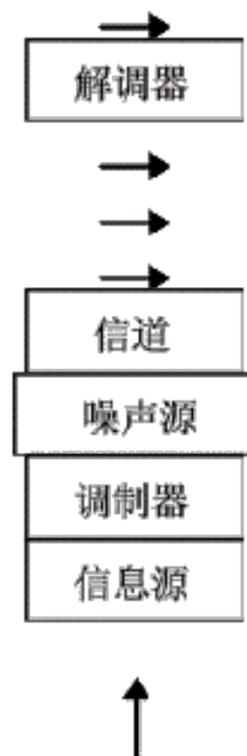
图 1-2 模拟通信系统模型
