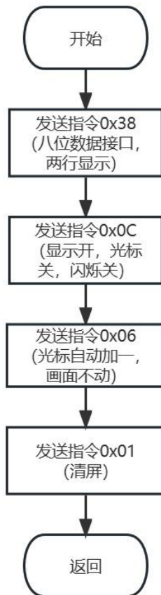
图 4-6 LCD1602 初始化流程图
