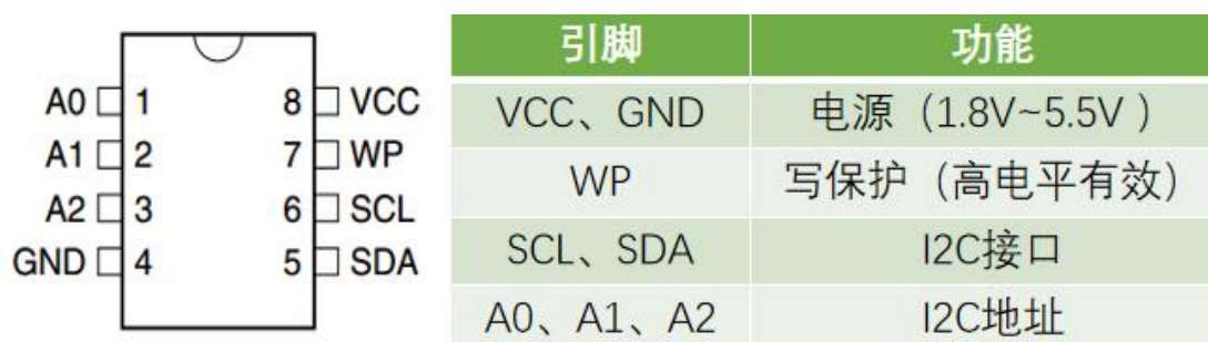
图 3-10 AT24C02 的引脚功能图
