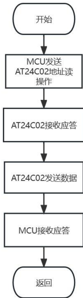
图 4-13 单片机读取 AT24C02 数据流程图
