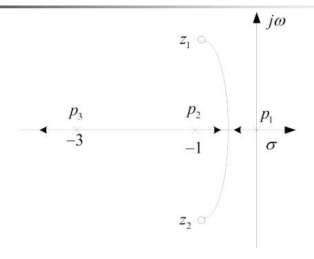
其中,"X"表示开环传递函数的极点(根轨迹的起点);"O"表示开环传递函数的零点(根轨迹的终点)。
