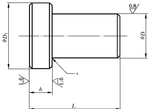
未注表面粗糙度  $R_a=6.3 \mu\text{m}$ ；未注倒角  $1 \text{ mm} \times 45^\circ$ 。
