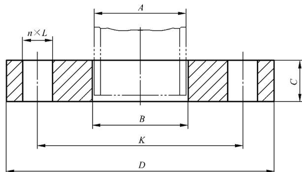
图 1 平面(FF)板式平焊钢制管法兰
