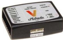
Das wesentliche Kriterium für den Einbauort ist die Verkabelung. Einerseits muß der Empfänger mit den Anschlußkabeln ohne Knicken oder Spannen erreicht werden, andererseits müssen die Taumelscheibenservos an die Zentraleinheit angeschlossen werden. Da der Heckkreisel mit einbezogen wird, ist auch das Heckservo hier anzuschließen.
