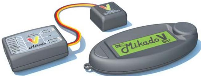
Für alle Komponenten muß ein geeigneter Platz am Heli gefunden werden. Bei der Zentraleinheit geht es vor allem um die Kabelführung, zum Empfänger, während der Gyro Sensor genau nach Längs- und Querachse des Helis ausgerichtet werden muß. Im folgenden wird beschrieben, worauf im Einzelnen zu achten ist.
