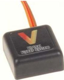
Wenn Driftbewegungen des Helis daraus resultieren, ist die Vibrationsbelastung zu hoch. In diesem Falle ist VStabi in diesem Heli nicht ohne weitere Maßnahmen zur Reduzierung der Vibrationsentstehung bzw. des Vibrationseintrages in den Sensor verwendbar. Verwenden Sie auf jeden Fall das mitgelieferte gelbe Klebepad. Es hat sich im Elektro- als auch im Verbrennerhubschrauber als besonders geeignet erwiesen.
